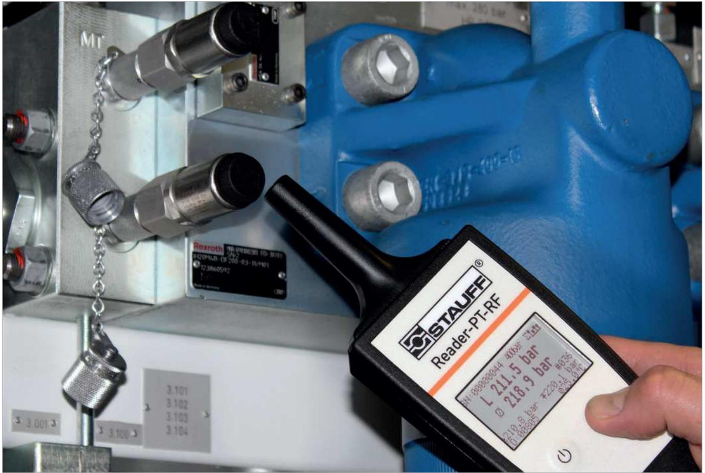
Con los transductores de presión de la serie PT-RF, STAUFF ofrece una alternativa en el área de la técnica universal de medición de presión para aplicaciones de técnica de fluidos, de las que se benefician durante el primer equipamiento no solo los operadores de los equipos, sino también los técnicos de mantenimiento y puesta a punto y los constructores de máquinas.
